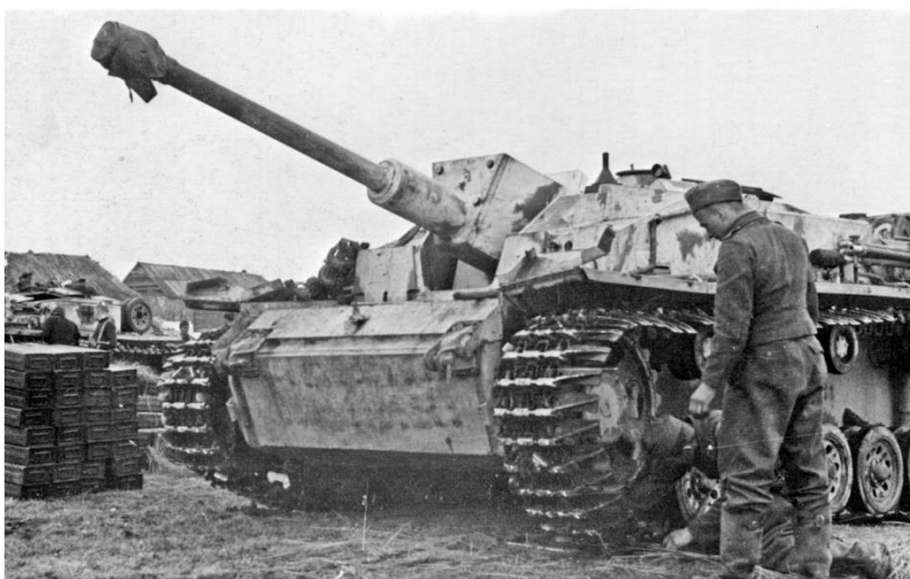
96 An diesem Sturmgeschütz mit der 7,5 cm L/48 ist von besonderem Interesse die sogenannte Ostkette. Es waren seitliche Verlängerungen der einzelnen Kettenglieder, die ein besseres Fahren im Schnee erlaubten, aber auch oft verloren gingen. (BA) A "Sturmgeschütz III" in action. The broader "Ostketten" ("Eastern tracks") are shown to advantage. "Ostketten" were used in Russia to give the tanks extra grip in snow and soft ground.
